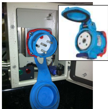
Connecteur (mâle) sur camion électrique
